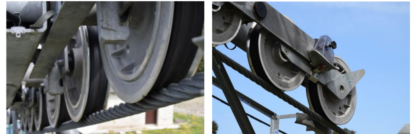
Ci-dessus: Zoom sur des balanciers et galets compression Poma.
