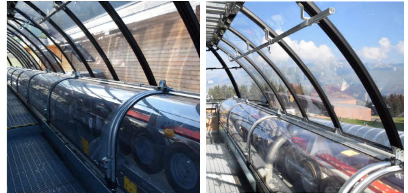
Ce dessus, un appareil Leitner, reconnaissable grâce à ses capots en plexiglass. Sur la photo ci-dessous (Doppelmayr), on distingue bien les courroies utilisées pour la transmission entre les pneus.
