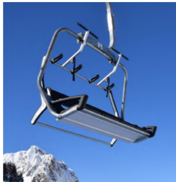
Sièges MND Ropeways, disponibles en plusieurs versions (Wind avec un dossier ajouré pour diminuer la prise au vent, Confort ou Eco).
