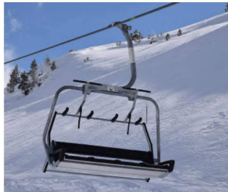
Sièges MND Ropeways, disponibles en plusieurs versions (Wind avec un dossier ajouré pour diminuer la prise au vent, Confort ou Eco).
